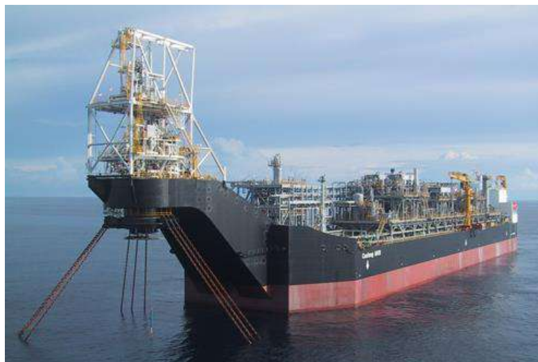
Figura 2.5 - Sistema de ancoragem Turret Externo em uma FPSO (MOORING SOLUTIONS SPECIALISTS, 2002)
