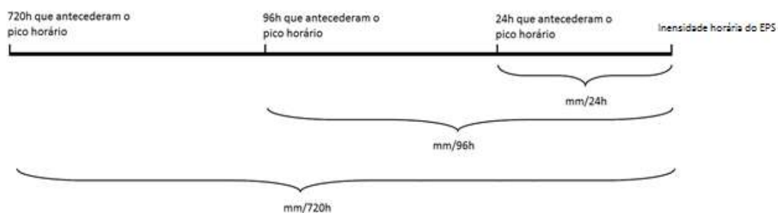
Figura 3.5 – Esquemática exemplificando os acumulados de chuva para mm/24h, mm/96h e mm/720h (Fonte: MENDES, 2016)
