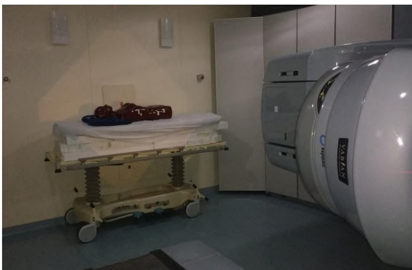
Figura 27: Posicionamento do fantoma durante o teste de ponta a ponta do TBI
