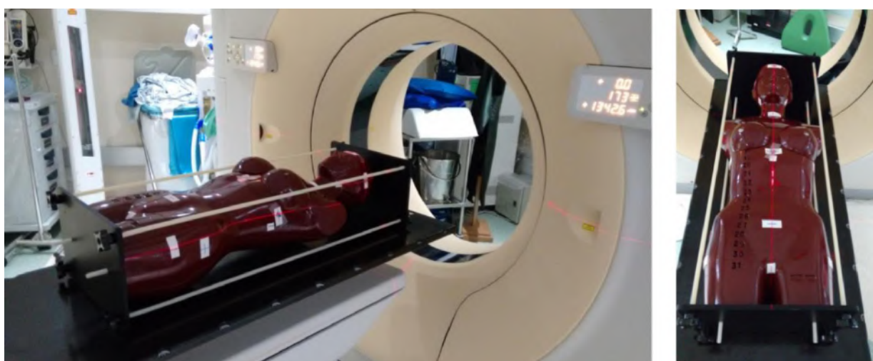
Figura 24: Posicionamento do simulador antropomórfico no tomógrafo
