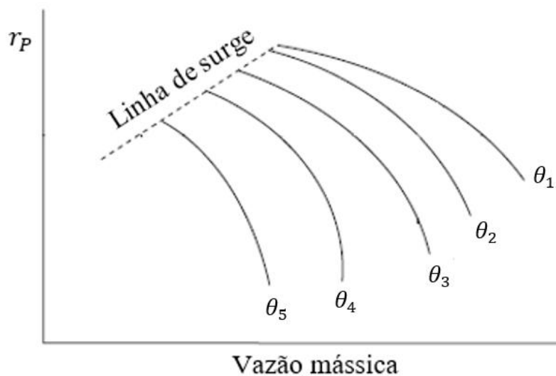
Figura 5.4 - Alteração do mapa do compressor com variação da posição das VIGV (adaptada de [129]).
