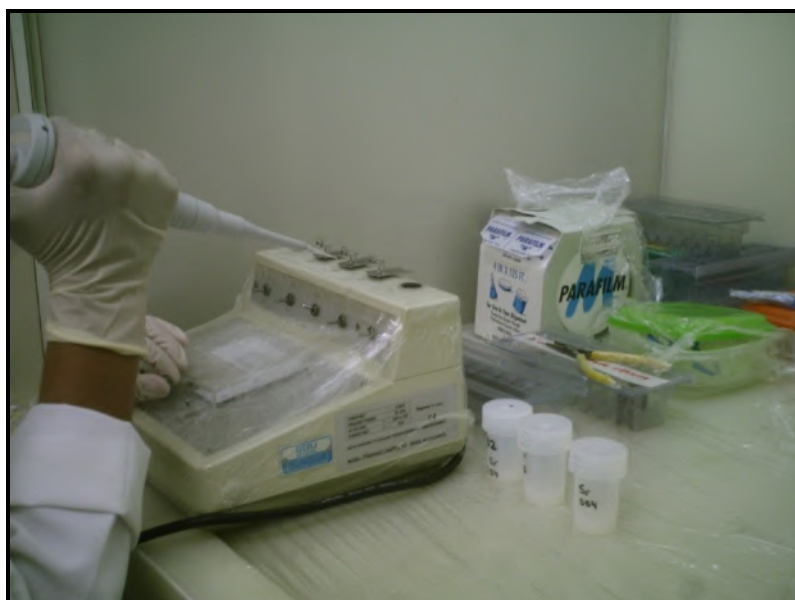
Figura 10 – Colocação da amostra diluída em 1 ml de HCl sobre o fio de Rênio para secagem e posteriormente posto no espectrômetro de massa.
