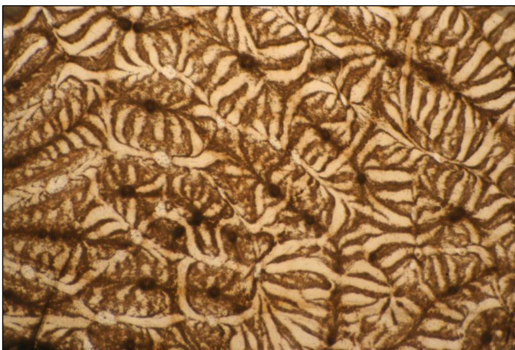
Figura 6 – Detalhe de uma lâmina plano-paralela cortada perpendicularmente às inclusões. (microscópio óptico de imersão, luz transmitida, largura: 6,0 mm)
