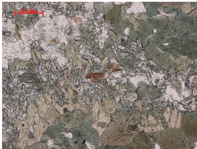
Figura 91 – Crescimento de biotita na região de contato entre a hornblenda e o plagioclásio epidotizado.
