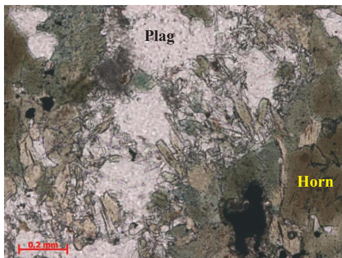
Figura 92 - Grãos de plagioclásio (plag) fortemente transformados para minerais do grupo do epidoto nas proximidades do contato com grãos de hornblenda (horn). Nicóis paralelos.
