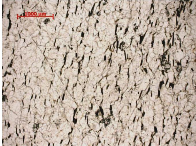
Figura 23 - Índice de cor leucocrático e a textura granolepidoblástica do gnaissse tipo I.
