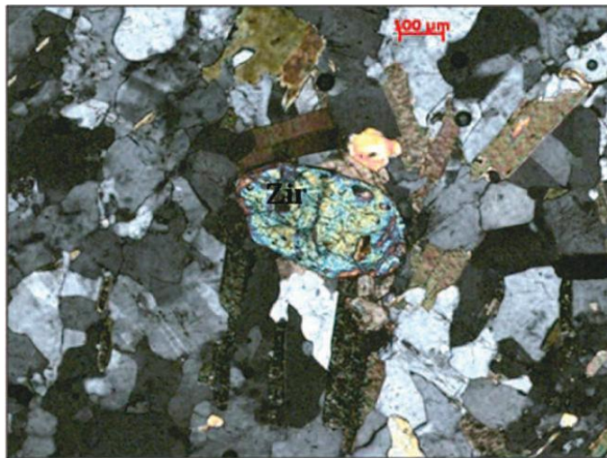
Figura 40 - Cristal de zircão (Zir) em associação com grãos de biotita em gnaiss do tipo III. Nicóis cruzados.
