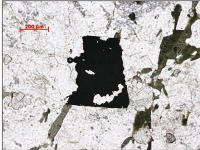
Figura 42 - Cristal de mineral opaco parcialmente corroído em amostra do gnaissse tipo III.
