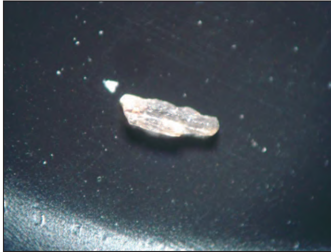
Figura 45 – Imagem em estereomicroscópio mostrando um grão de cianita do gnaissse tipo III.
