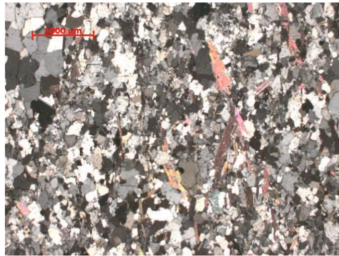
Figura 32 - Textura heterogranular do gnaissse tipo II.
