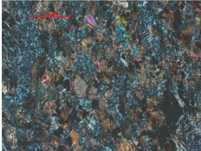
Figura 51 – Serpentinito mostrando porções com o predomínio de serpentina (azul) + opacos e porções com maior quantidade de tremolita + talco (minerais coloridos). Nicóis cruzados.
