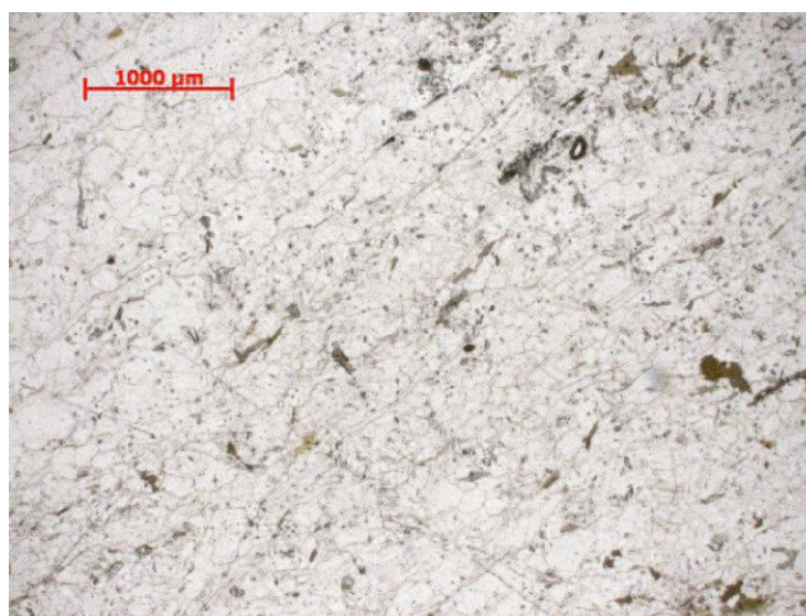
Figura 30 - Índice de cor hololeucocrático do gnaissse tipo II.
