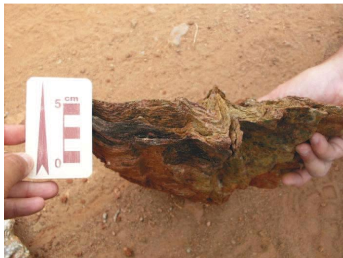
Figura 70 – Talcosito foliado com crenulação bem marcada, diferentemente dos talcositos maciços.
