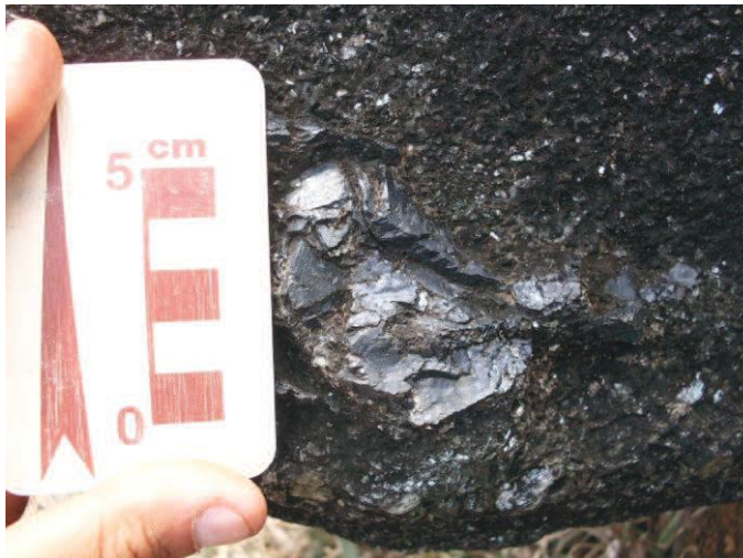
Figura 77 - Detalhe de um cristal centimétrico de ilmenita em meio ao cloritito fino a médio.
