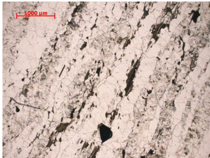
Figura 24 – Bandamento metamórfico do gnaissse tipo I.
