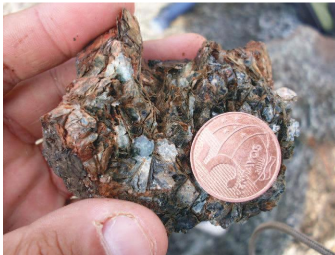
Figura 74 - Detalhe do cloritito de granulação grossa.
