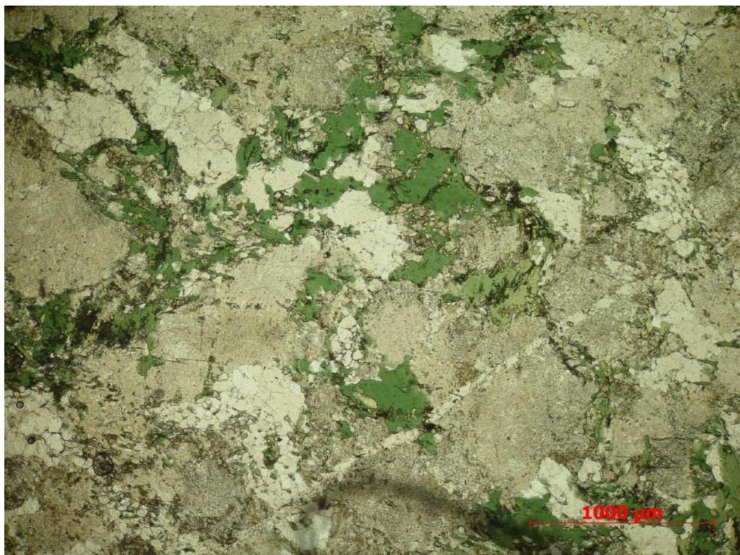
Figura 13: Cloritas anédricas de cor verde posicionadas entre grãos de feldspato e quartzo.
