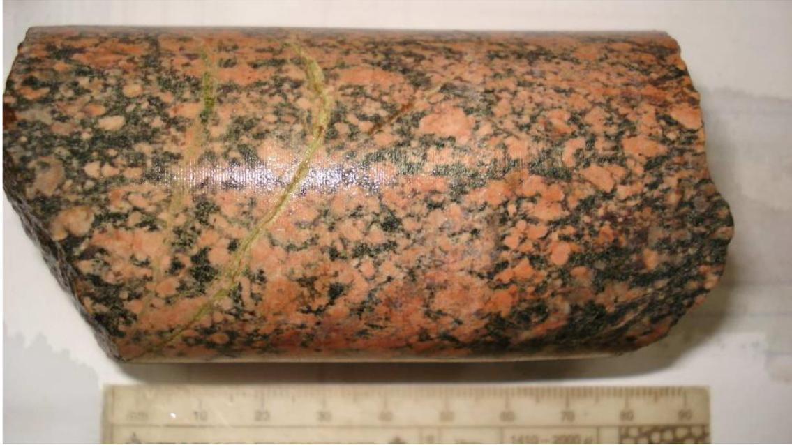
Figura 5: Grãos de feldspato de diferentes tamanhos. Notar fratura preenchida por epidoto. Ressalta-se que a tonalidade rosa se deve à oxidação superficial e a efeitos da luz na sala de testemunhos.
