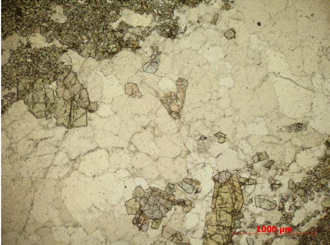
Figura 17: Epidotos médios, com grau de desenvolvimento euédrico e fraturados.
