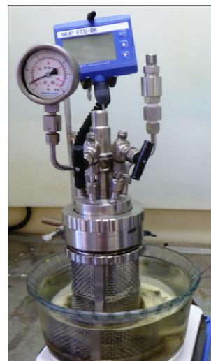
**Figura 13. Reator tipo Batch**
