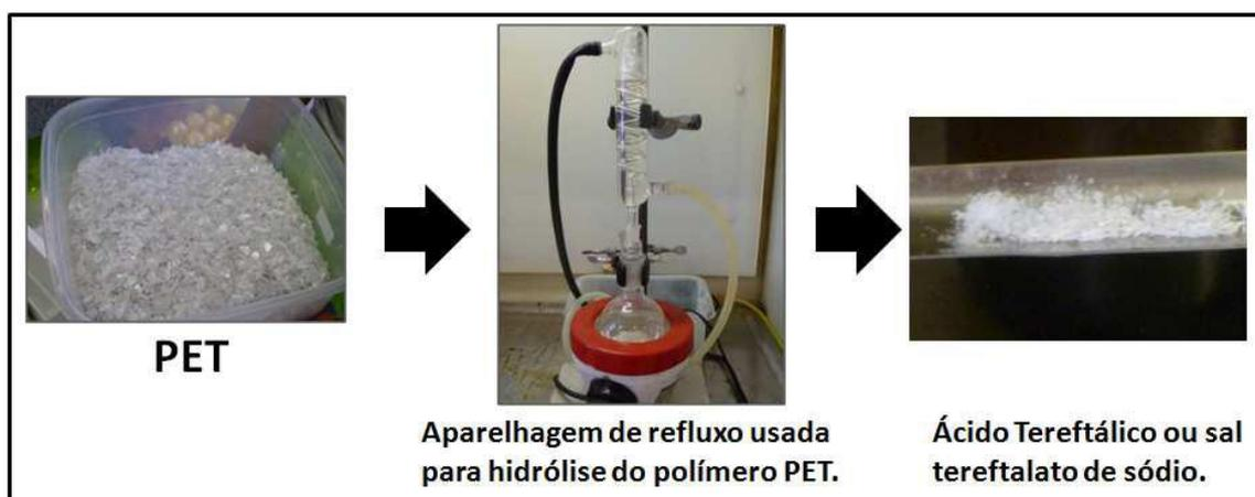
Figura 6. Obtenção do ácido tereftálico
