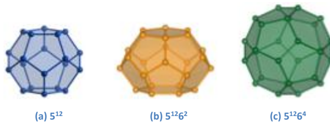
Figura 2: Alguns tipos de cavidades que formam hidratos [adaptado de Amadeu K. Sum et al. - Center for Hydrate Research Overview, 2011]
