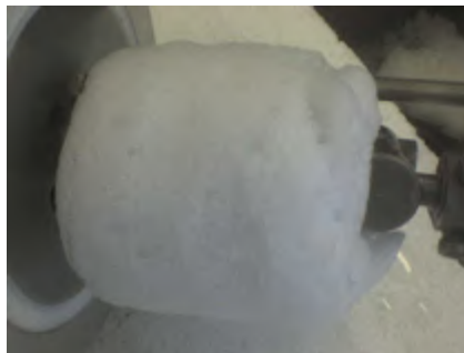
Figura 9: Foto do hidrato de metano formado nos testes em branco
