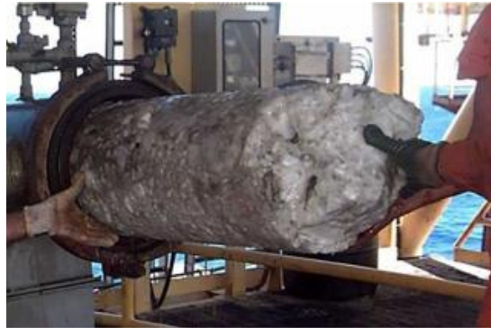
Figura 3: Exemplo de estrutura cristalina de hidratos adaptado de Amadeu K. Sum et al. - Center for Hydrate Research Overview, 2011] Figura 4 : Plug de hidrato em linha de produção
