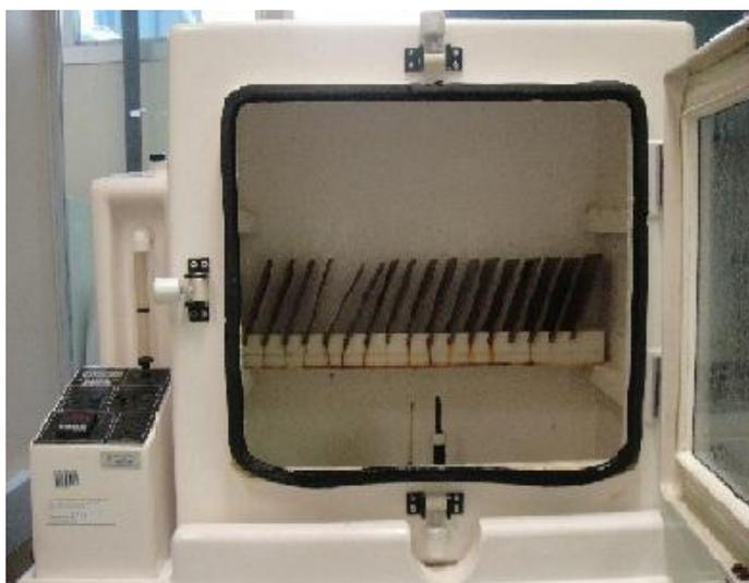
**Figura 5-** Câmara de umidade.
