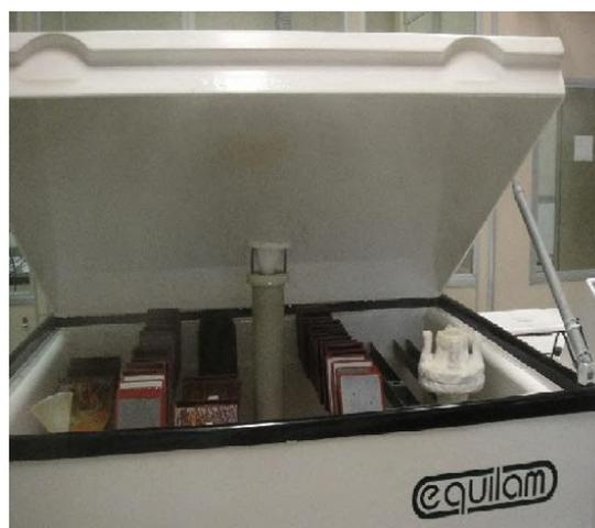
**Figura 4-** Câmara de névoa salina.
