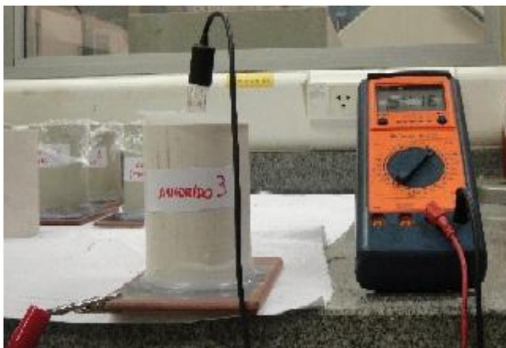
**Figura 6-** Esquema de montagem do ensaio de potencial de circuito aberto.
