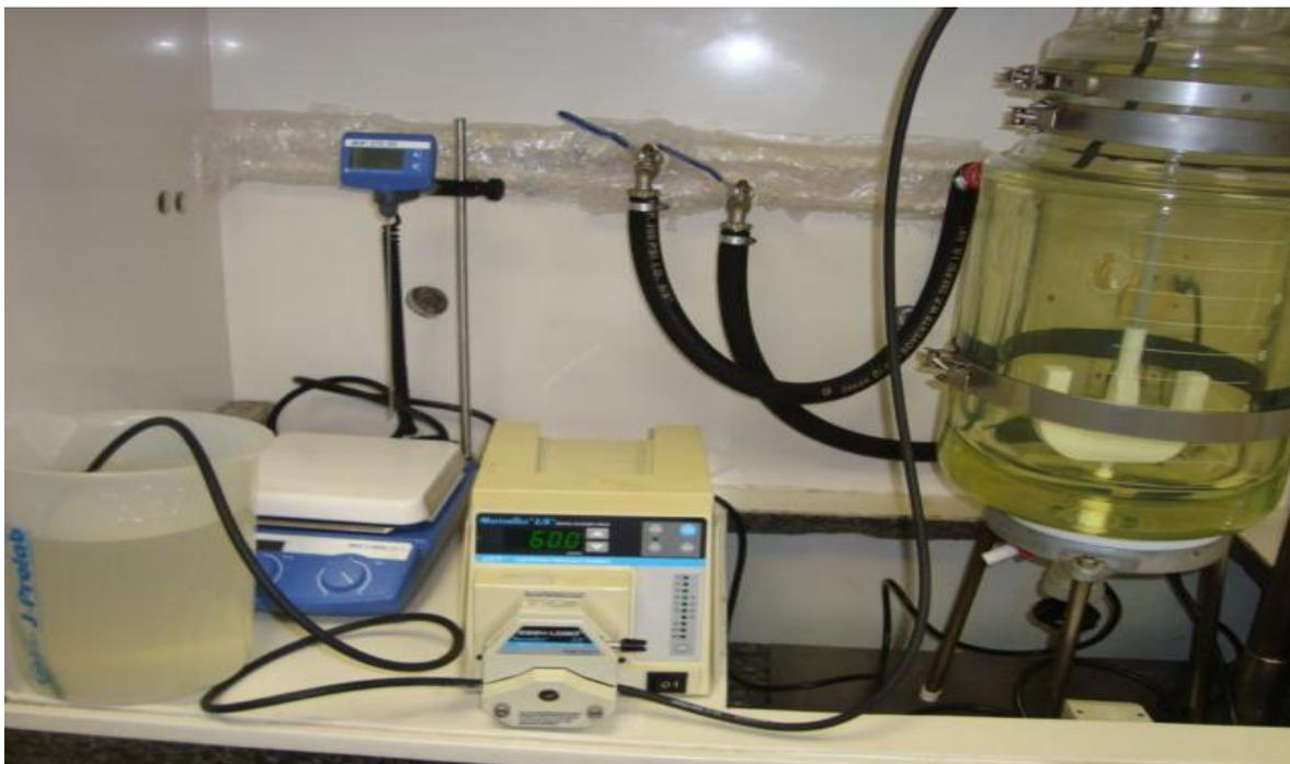
**Figura 5** – Aparelhagem utilizada na síntese do OCP.
