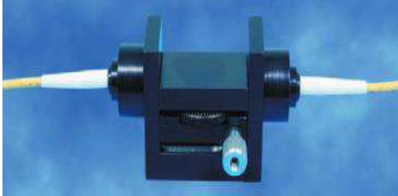
Figura 4.13: Filtro sintonizável de Fabry-Perot da Oz Optics [42]
