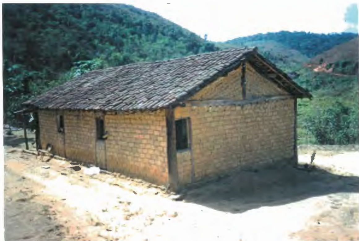
Antiga casa de colono construída por Seu Osório. Técnica: adobe
