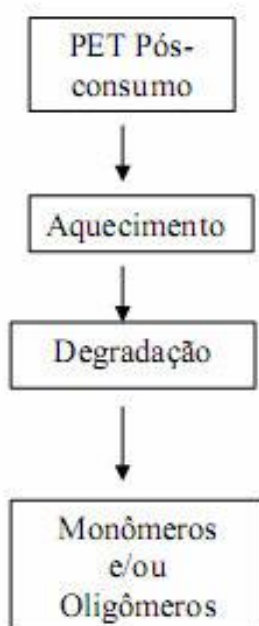
Figura 26 - Diagrama genérico da reciclagem química (NASCIMENTO, 1996)
