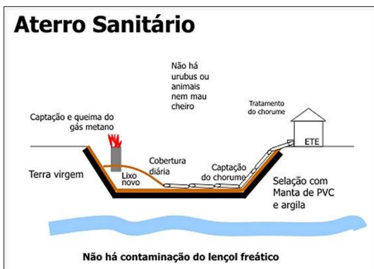
Figura 16 – Esquema de aterro sanitário (POSSANTE ON LINE, 2009)
