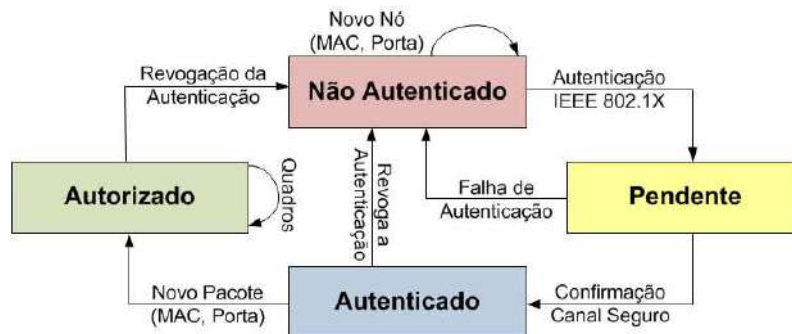
Figura 3.2: Diagrama de estados do controle de acesso do mecanismo AuthFlow. i) Estado Não autenticado, quando a estação não iniciou o processo de autenticação; ii) estado Pendente, enquanto o processo de autenticação foi finalizado; iii) estado Autenticado, quando a estação já finalizou a autenticação com sucesso; iv) estado Autorizado, quando a estação está autorizada a usar a rede.
