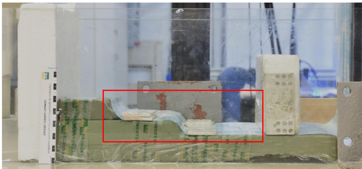
Figura 33: Configuração do experimento 2, mostrando a geometria de rampas curvas côncavas separadas por plataforma horizontal, assinalada pelo retângulo vermelho.
