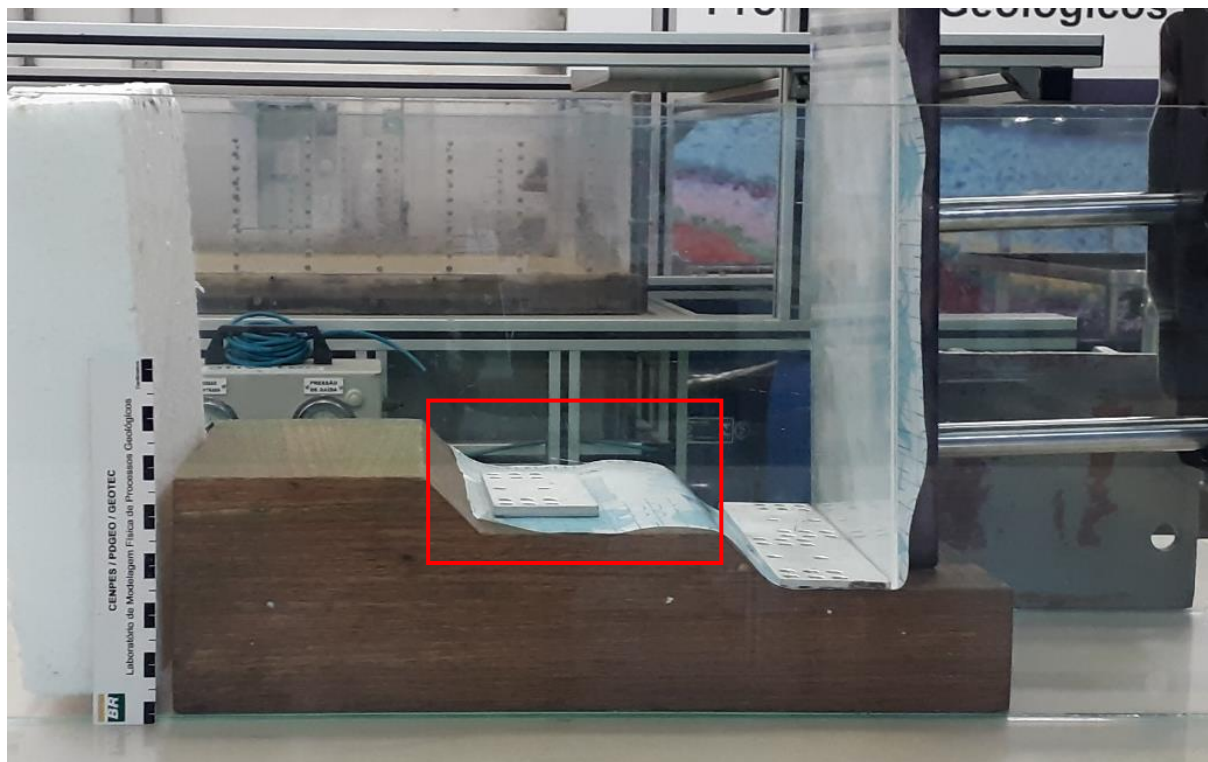
Figura 29: Configuração do experimento 1, mostrando a geometria rampa-plataforma planar no bloco rígido de madeira. O retângulo vermelho define a região de rampa e plataforma superior analisada no final do experimento.
