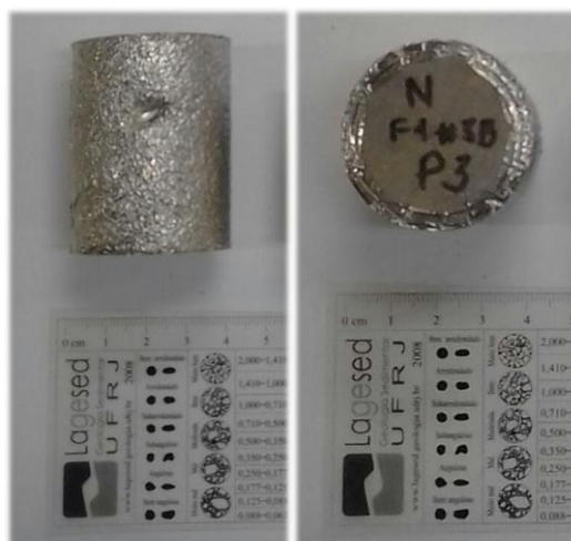
Figura 14: A fotografia à esquerda ilustra o plug com encapsulamento de Ni, ao longo do eixo mais longo (amostra F1#3B-P3); à direita indicando o mesmo plug com o topo com a tela metálica. Extraído de Vogel (2018).
