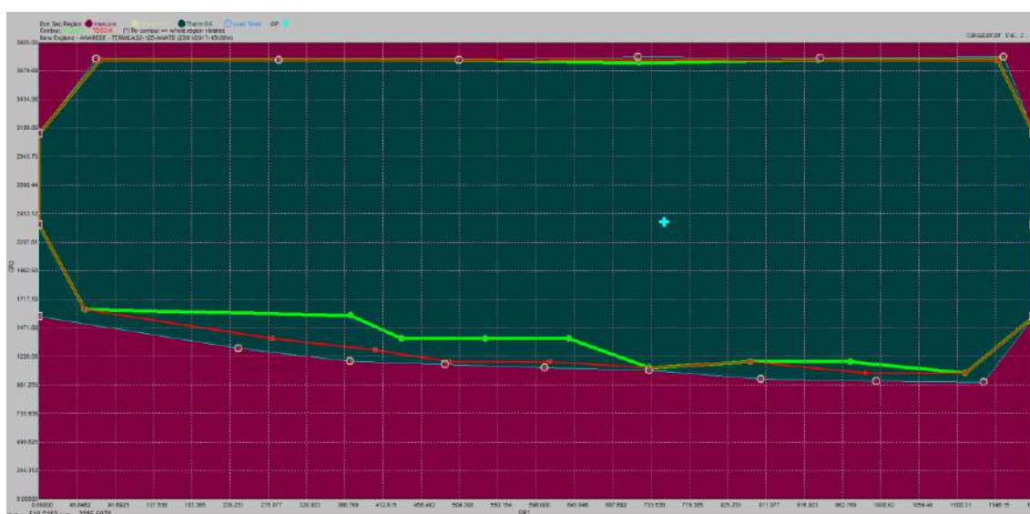
Figura 79 - RSD - malha central - parque gerador misto - patamar de carga pesada - 100% corrente constante
