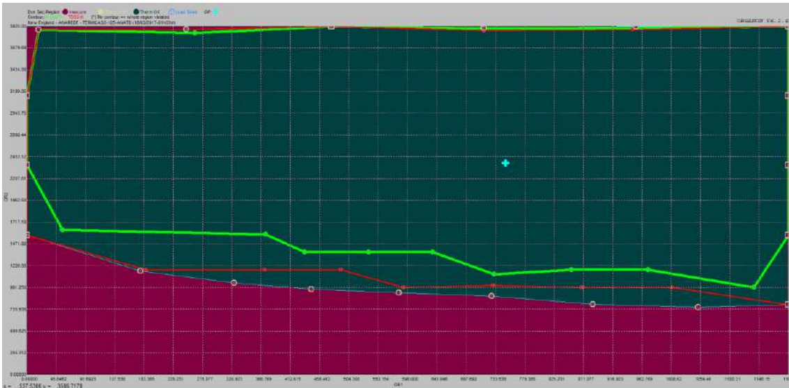
Figura 83 - RSD - malha central - parque gerador misto - patamar de carga pesada - 100% impedância constante desconsiderando a perda simples da LT 116-117
