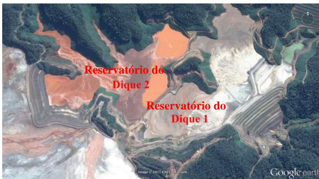
Figura 4.1 - Imagem de satélite da Barragem do Fundão em 2015, com os reservatórios que a compunham (adaptado de FLÓREZ, 2015)
