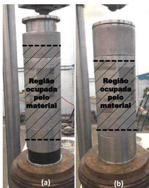
Figura 5.2 - (a) Conjunto antes da compactação; (b) Conjunto após a compactação
