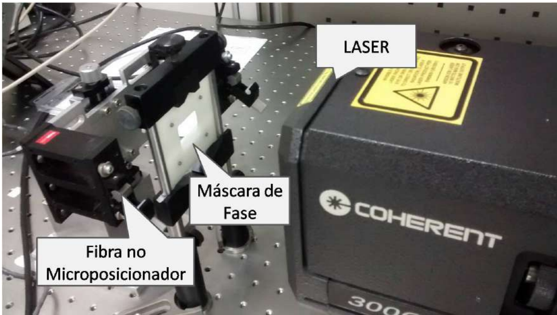
Figura 3.3: Foto do aparato que inclui o laser de argônio, a máscara de fase e a fibra ótica em um suporte microposicionador.
