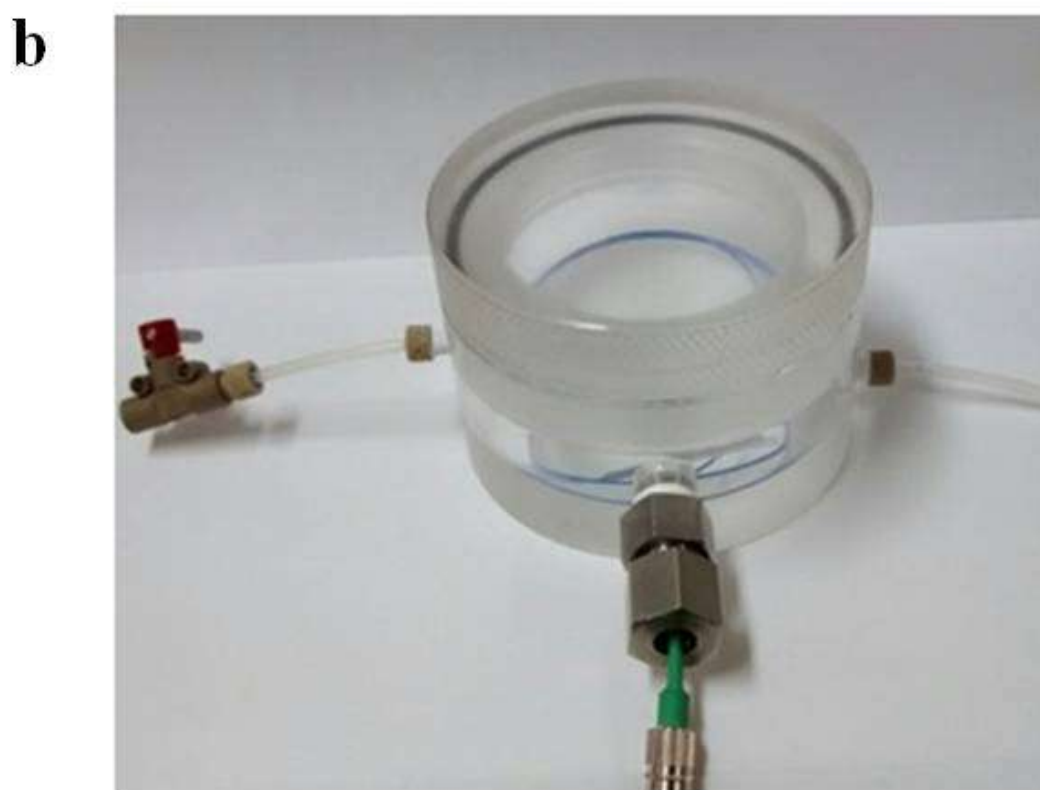
Figura 3.13: Esquema de como funciona o aparato para medição de H_2S (a) e câmara utilizada para injeção do gás (b).
