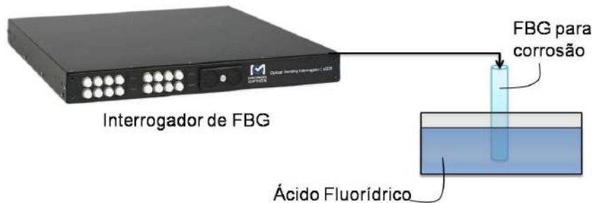
Figura 3.5: Método para interrogação em tempo real durante o processo de remoção da casca da fibra ótica
