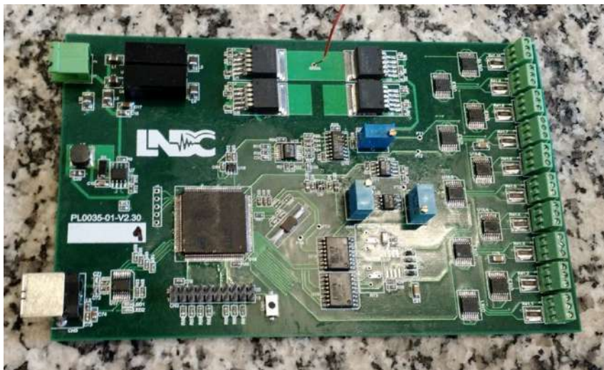
Figura 3.8: Placa para excitação, processamento e aquisição dos sinais provenientes das bobinas utilizados nos ensaios de correntes parasitas.
