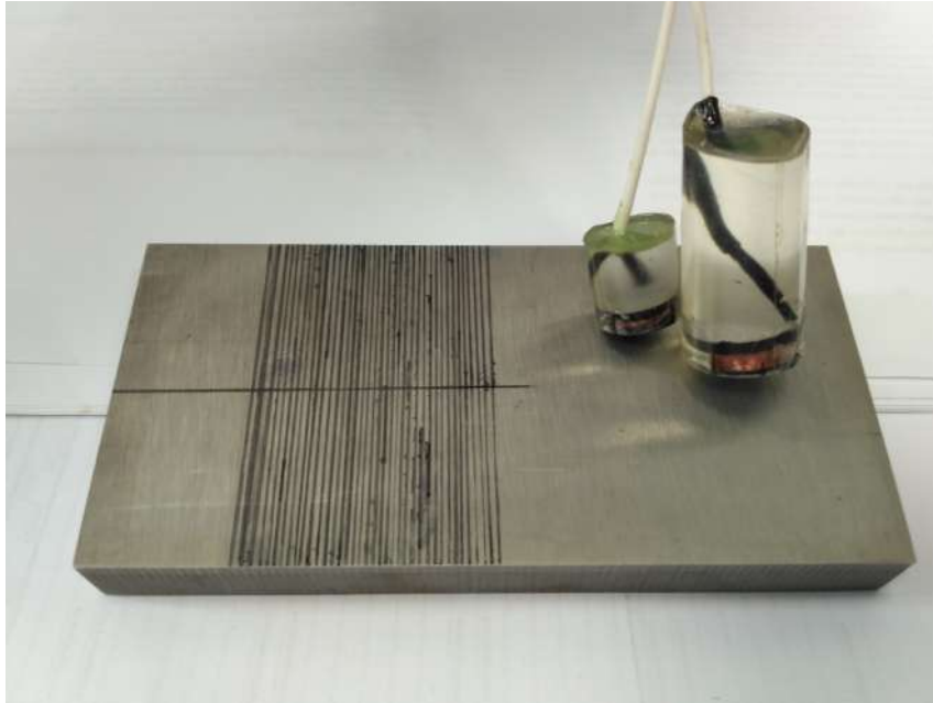
Figura 3.7: Corpo de prova de aço cladeado com entalhe e bobinas utilizados na validação experimental dos dados simulados.
