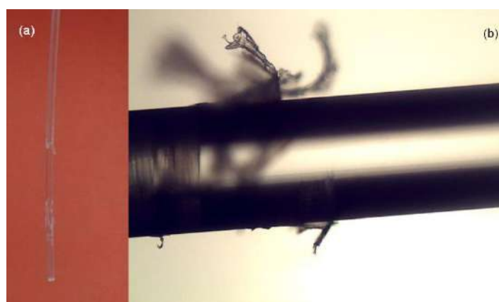
Figura 4.1: (a) POF descascada; (b) Ampliação da área descascada. Observa-se parte da casca solta na interface da região com casca/sem casca.
