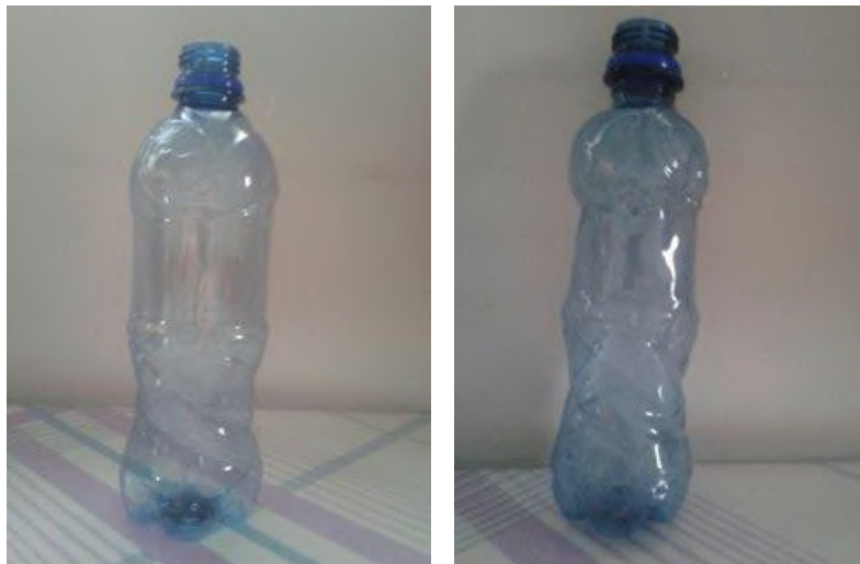
Figura 5. Garrafa PET antes e após contato com água quente.
