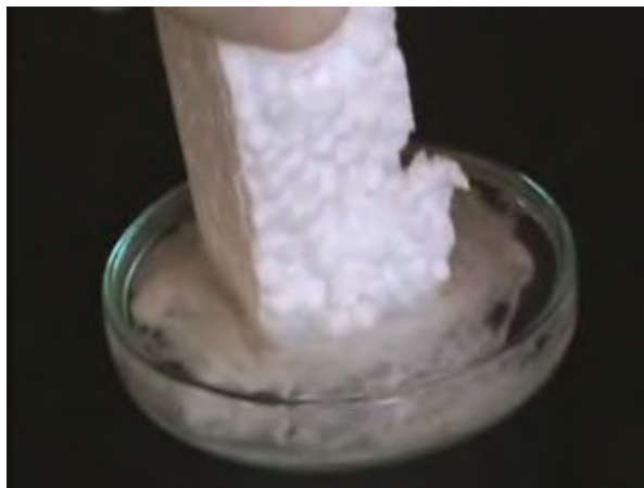
Figura 10. Dissolução de um pedaço de isopor em gasolina.
