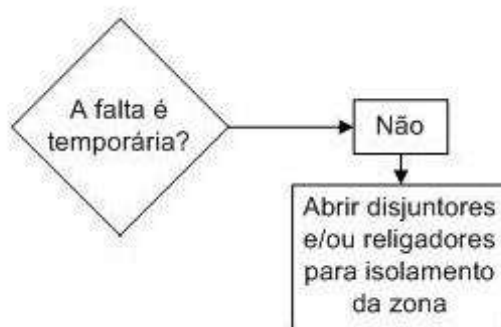
Figura 33 - Sétimo passo do algoritmo de identificação de falha on-line
