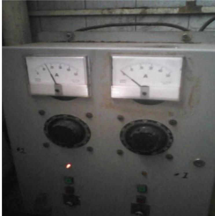
FIGURA 8 – Equipamento para eletrodeposição
