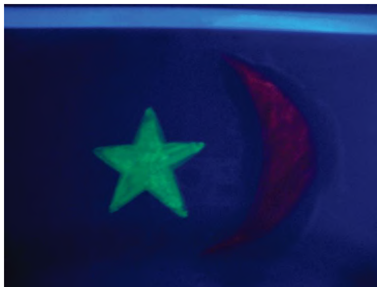
Figura 10. Efeito causado ao acender a lâmpada UV após posicionar a parte da transparência com protetor apenas sobre o desenho da lua.
