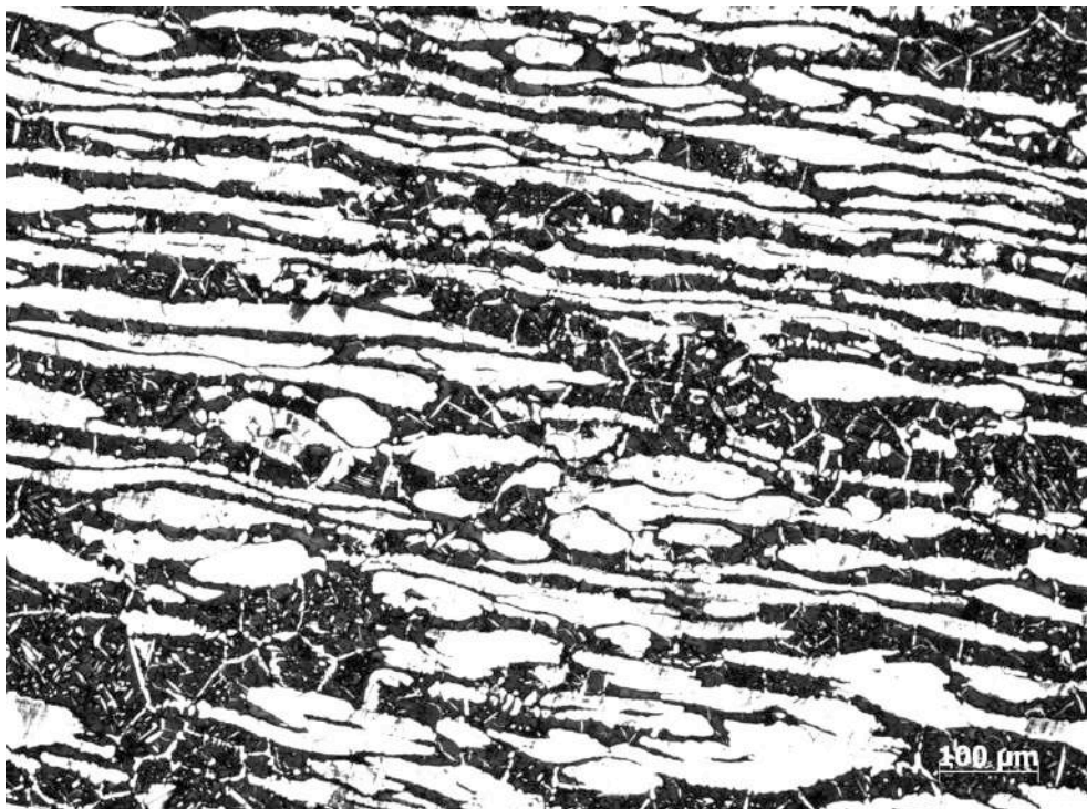
Figura 43: Micrografia do metal de base (MB) com aumento de 200x. A região preta corresponde à fase ferrítica e a branca, à fase austenítica.
