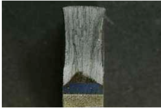
Figura 53: Superfície de fratura evidenciando a ocorrência de tunelamento da trinca (adaptado de [77]).
