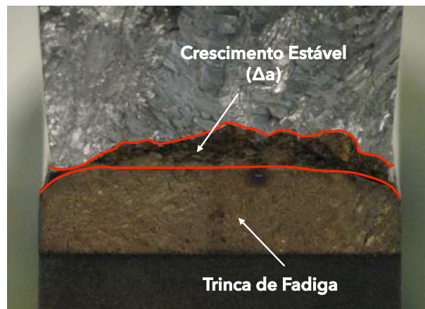
Figura 35: Estereoscopia da superfície de fratura do corpo-de-prova após o “ heat tinting ”.
