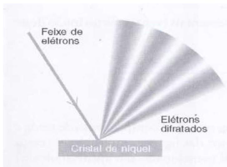
Figura 21- experiência de Davisson- Germer. O espalhamento de um feixe de elétrons por um cristal de níquel mostra uma variação de intensidade característica de uma difração, na qual as ondas interferem construtiva ou destrutivamente em diferentes direções no espaço (ATKINS e JONES, 2008).
