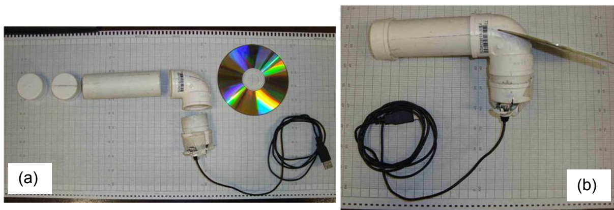
Figura 11 - (a) Visão explodida do espectrôscópio; (b) visão montada do espectrôscópio (PLATENIK, G. 2012)
