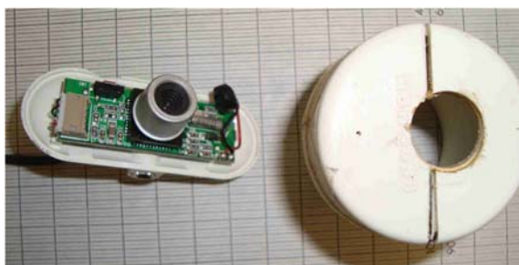
Figura 8 - Abertura para a webcam de acordo com o tamanho da lente (PLATENIK, G. 2012)
