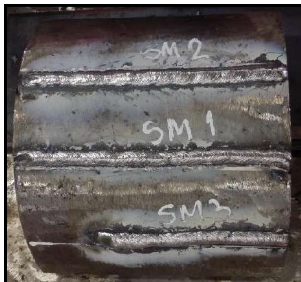
Figura 56. Cordões de simples deposição soldados por processo SMAW.
