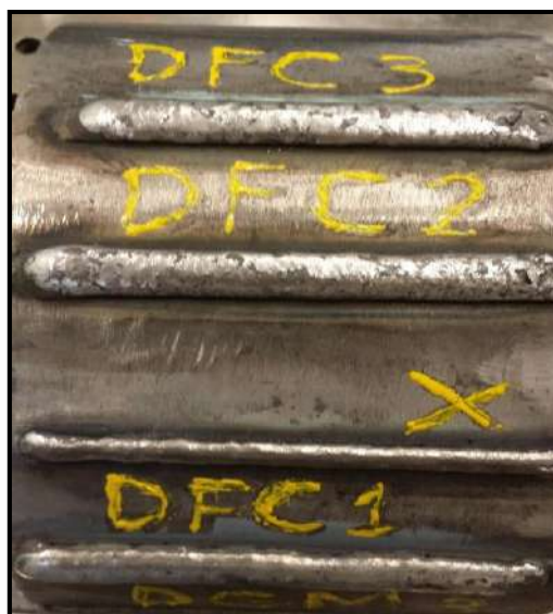
Figura 71. Cordões de dupla camada soldados por processo FCAW. O cordão identificado com X foi descartado.
