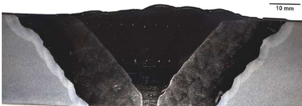
Figura 104. Macrografia da junta amanteigada.
