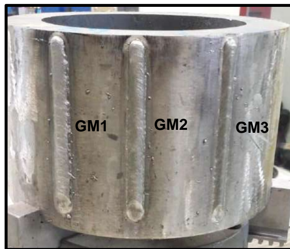
Figura 53. Cordões de simples deposição soldados por processo GMAW
