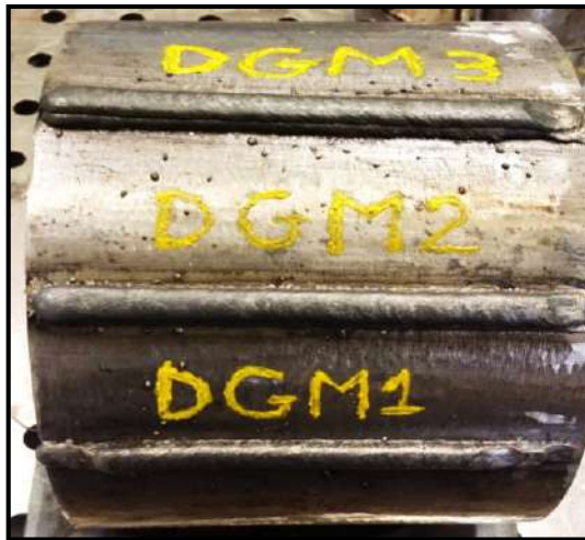
Figura 72. Cordões de dupla camada soldados por processo GMAW
