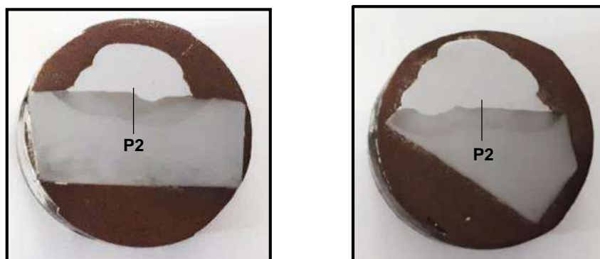
Figura 46. Identificação do local de ensaio de microdureza nas amostras de dupla e tripla camada.
