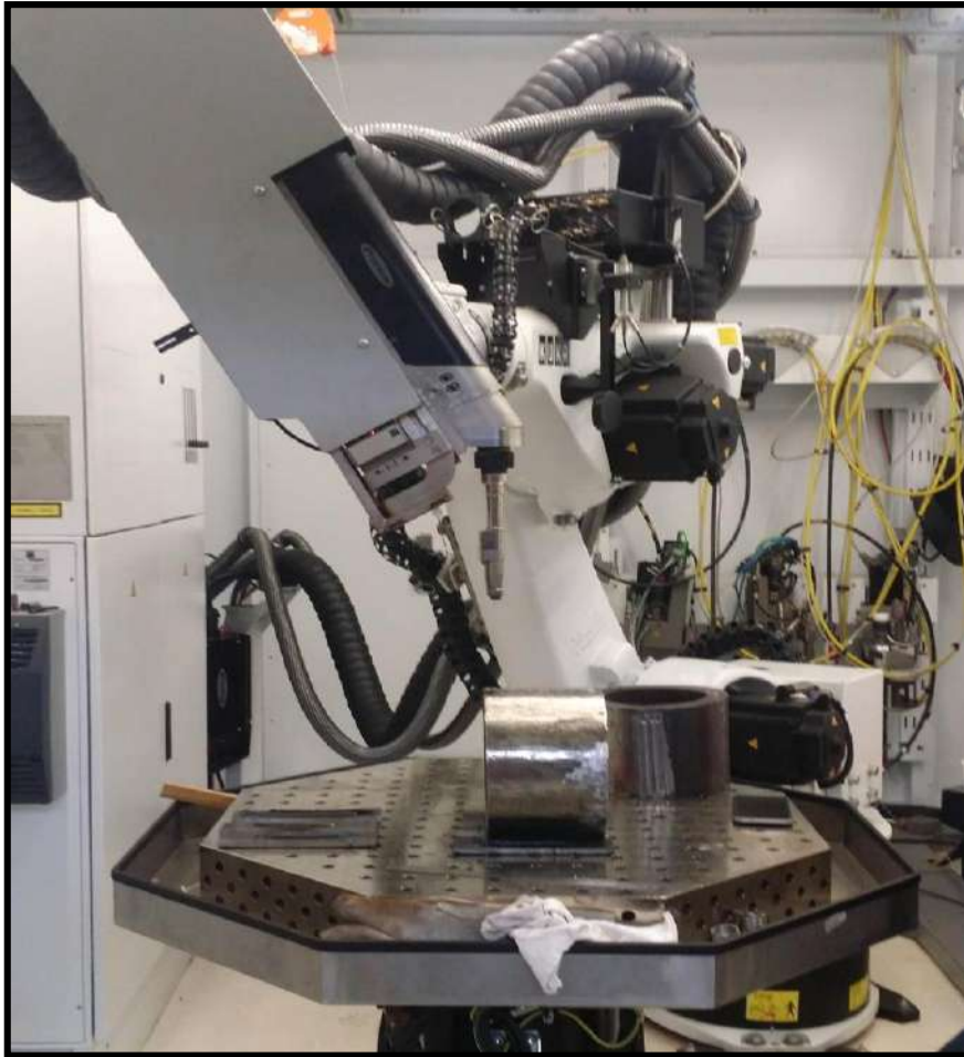
Figura 43. Equipamento de soldagem robotizada (Kuka)
