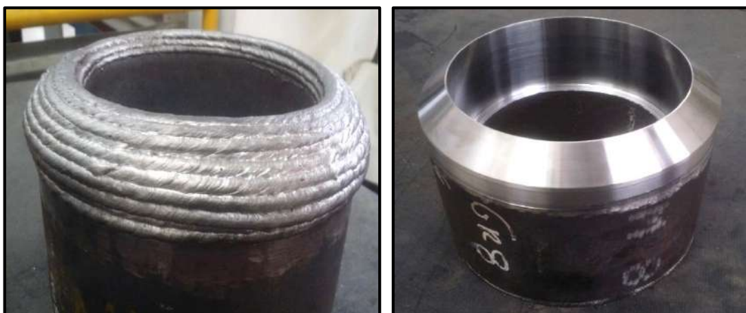
Figura 101. Bisel amanteigado antes e depois da usinagem.
