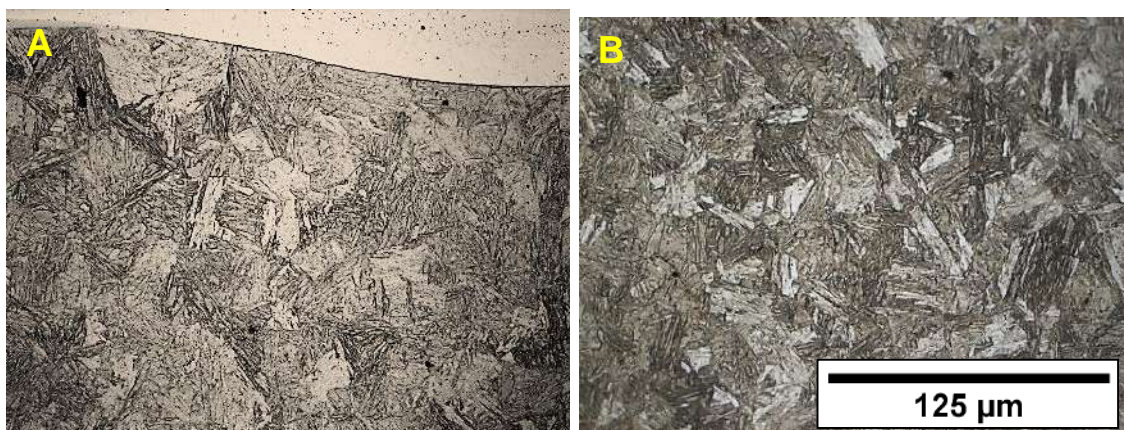
Figura 91. a) ZTAGG – primeira camada (SM1) e b) ZTA-GG – dupla camada (DSM2)
