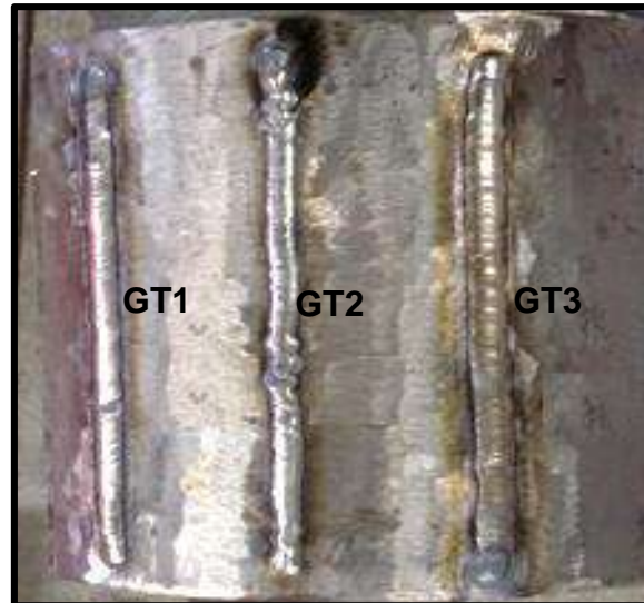
Figura 55. Cordões de simples deposição soldados por processo GTAW.
