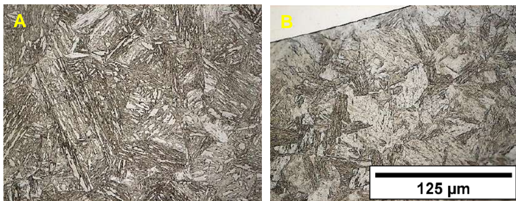
Figura 83. a) ZTAGG – primeira camada (GT3) e b) ZTA-GG – dupla camada (DGT1)
