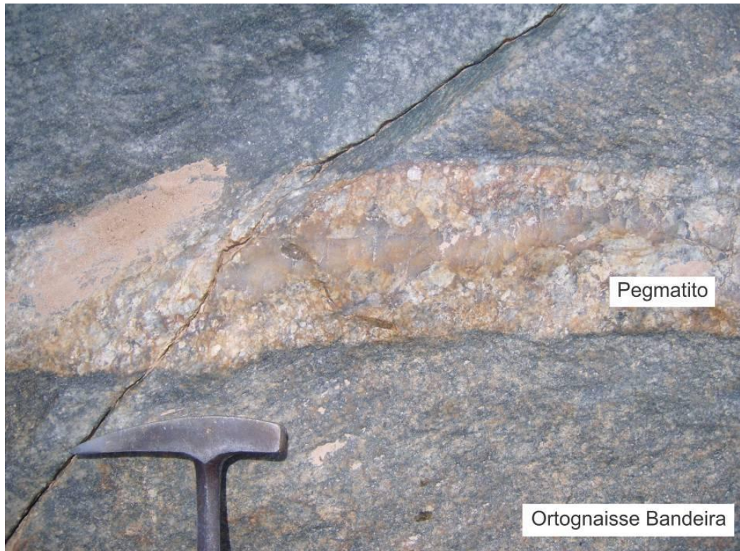
Figura 123: Pegmatito, com núcleo quartzoso da terceira geração truncando a foliação impressa no ortognaisse tonalítico Bandeira. Ponto ST-217.
