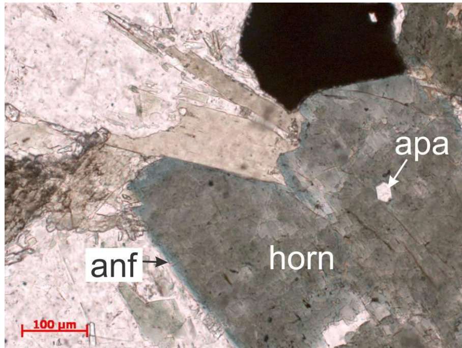
Figura 61: Detalhe do anfíbólio verde azulado (anf) na borda de um cristal de hornblenda (horn) com inclusão de apatita (apa). Lâmina ST-323A. Nicóis paralelos.
