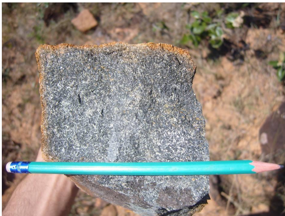
Figura 27: Amostra de metapiroxenito fresco, onde as cores esbranquiçadas resultam da reflexão da luz na superfície dos cristais de piroxênio. Ponto ST-124.
