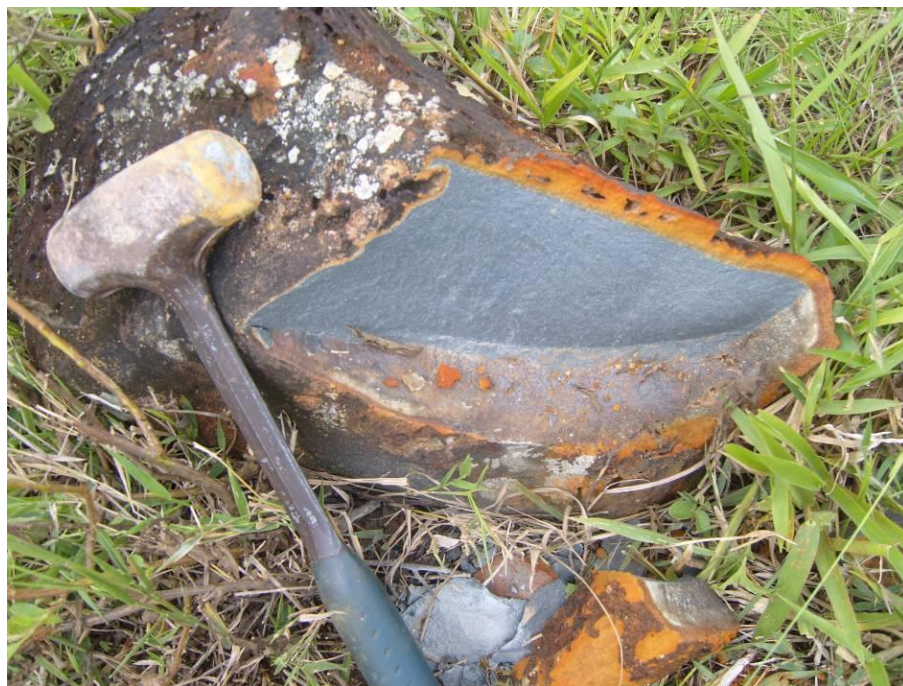
Figura 129: Bloco de diabásio onde se destaca a presença de uma camada envoltória de coloração amarelada, representativa da alteração intempérica. Ponto ST-144.
