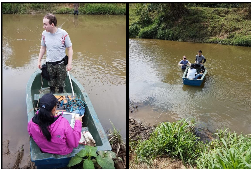
Figura 10. Aquisição dos dados geofísicos de uma seção batimétrica com o equipamento WPR no interior de um barco de fibra, ao longo de uma das tiragens de perfil no rio Paquequer.
