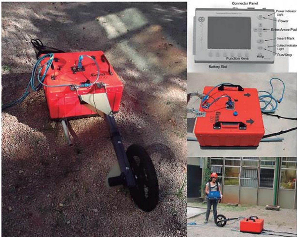
Figura 9. Equipamento de origem norte-americana da empresa GSSI ( Geophysical Survey System, Inc. ) modelo SIR 3000 composta de antena blindada de 200 Mhz.
