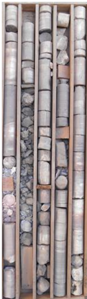
Figura 4.1- Caixa contendo os testemunhos de sondagem do poço 1-UN-15. Fica evidente o caráter intensamente alterado da rocha, com constante fraturamento e concentração de veios.
