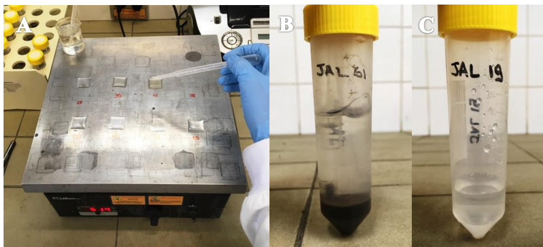
Figura 13- (A) Procedimento de preparação de lâminas na chapa aquecida; (B) Tubo de centrífuga com boa recuperação de matéria orgânica; (C) Tubo de centrífuga com baixa recuperação.
