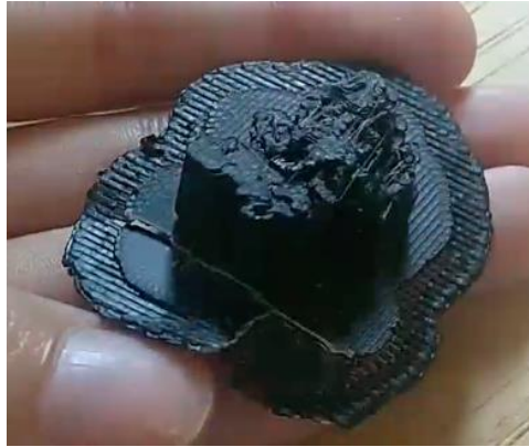
Imagem 12 - Modelo 3D impresso com erro e em escala errada
