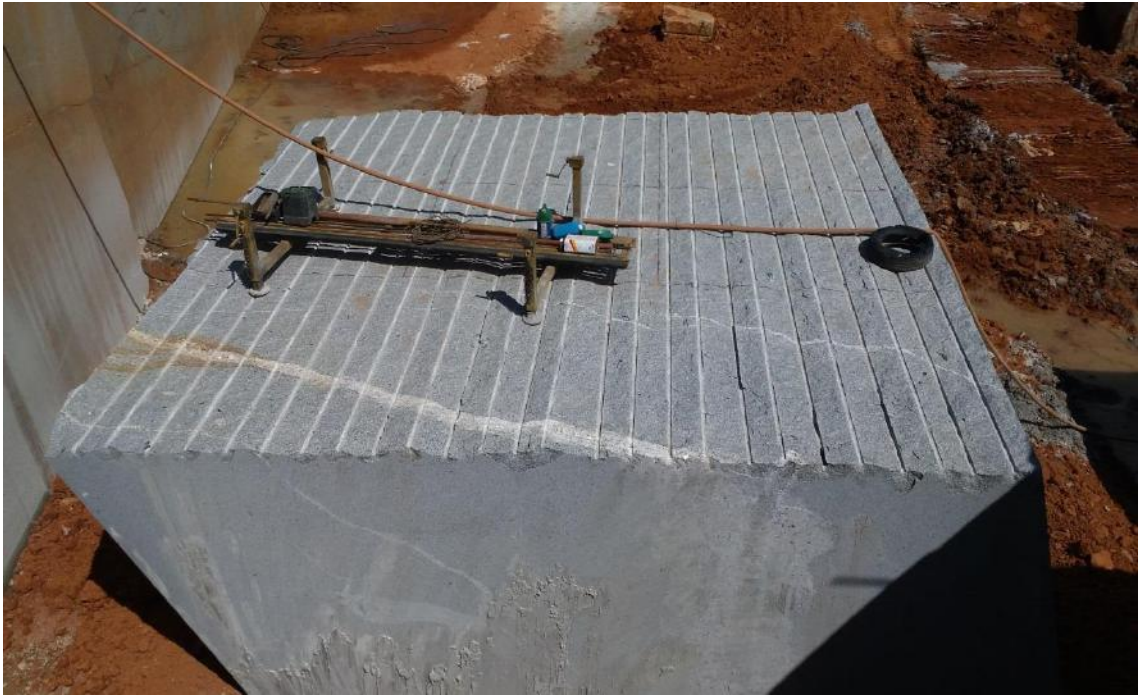
Figura 13 – Bloco sendo cortado para rocha ornamental. Injeções aplíticas são comuns cortando o granito.
