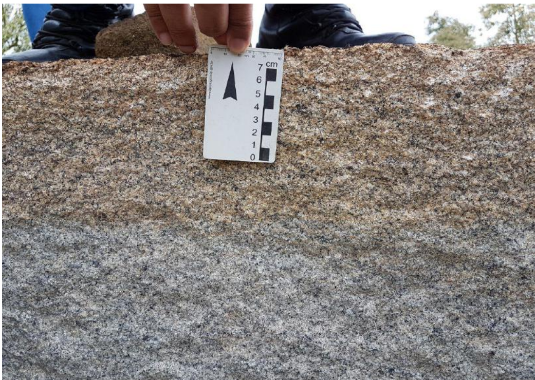
Figura 14 - Contato entre diferentes classes de alteração do granito (Jaques, 2018).
