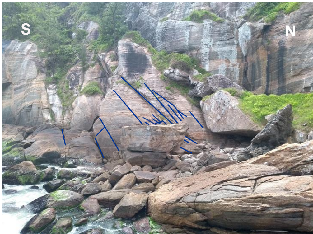
Figura 68: Fraturas no Ortognaisse e em intrusões subparalelas, com direção leste – oeste e mergulho subvertical
