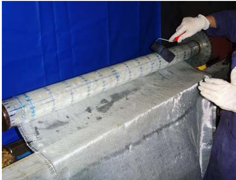
Figura 9: Aplicação da resina epóxi sobre a manta.
