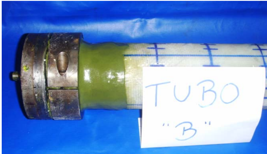
Figura 30: Extremidade do tubo B selada
