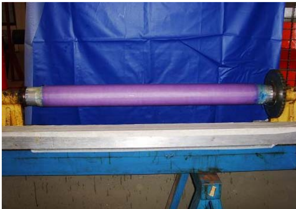
Figura 11: Aplicação do Peel Ply
