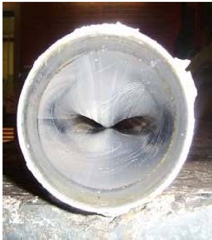
Figura 32: Seção transversal colapsada do tubo A
