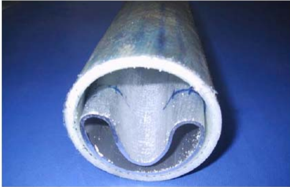
Figura 31: Modo de falha do tipo U devido à ausência de proteção externa.
