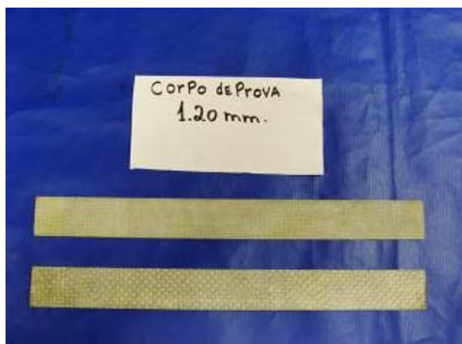
Figura 20: Modelo do Corpo de Prova para o teste de Tração (Modelo CP01)
