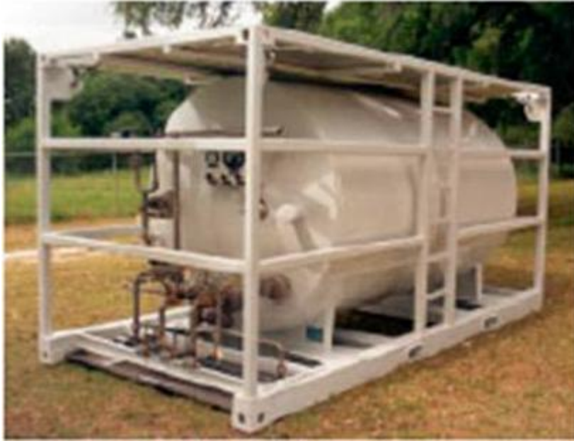
Figura 4.3 – Tanque offshore com 2000 gal. de capacidade. (PETROBRAS; SOTEP, S. Considerações sobre o Nitrogênio)
