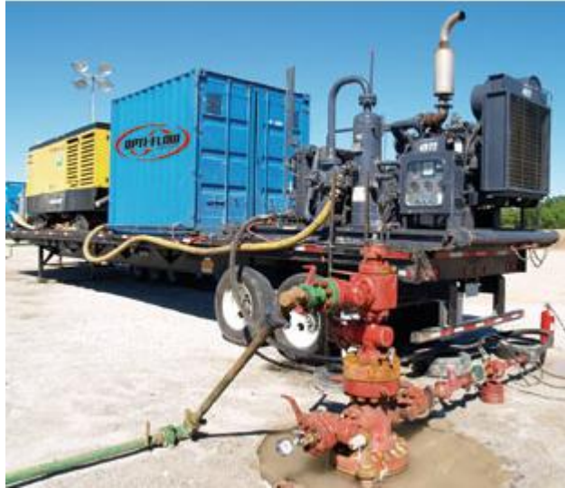
Figura 4.4 – Unidade de geração de nitrogênio in situ . (Fonte: http://www.optiflowgaslift.com/nitrogensvcs.html )
