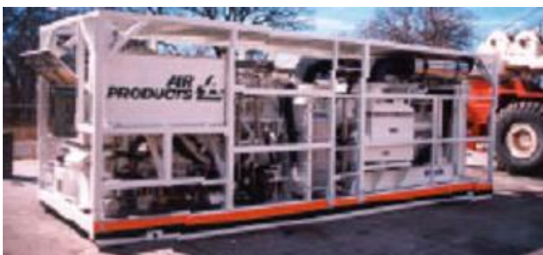
Figura 4.1 – NPS540HR10: 540.000 SCFH / 10.000 PSI. (Fonte: PETROBRAS; SOTEP, S. Considerações sobre o Nitrogênio )
