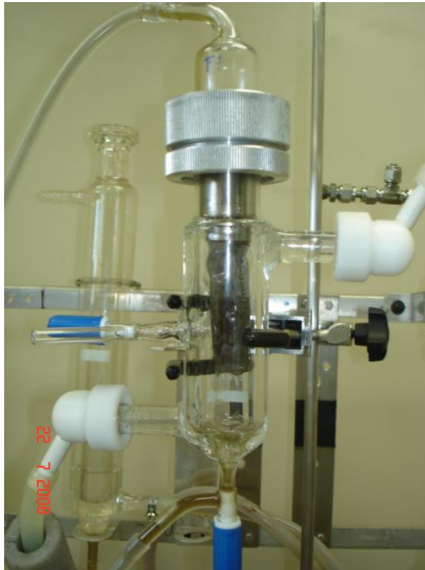
Figura 5 - Coluna de vidro toda montada já com a cesta metálica, utilizada no novo método de limpeza da areia
