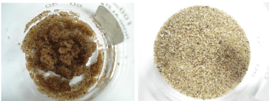
Figura 8 - Areia de fraturamento 20/40 limpa, a esquerda ainda molhada, e a direita após secagem na estufa
