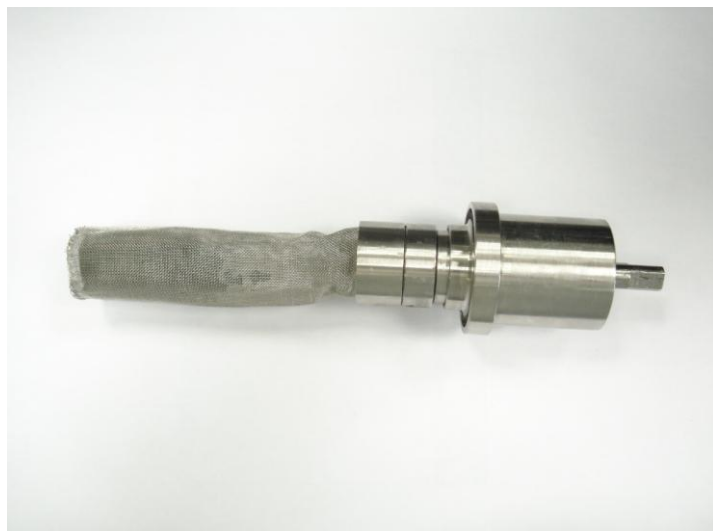
Figura 9 - Cesta metálica com adaptação para conectar ao motor
