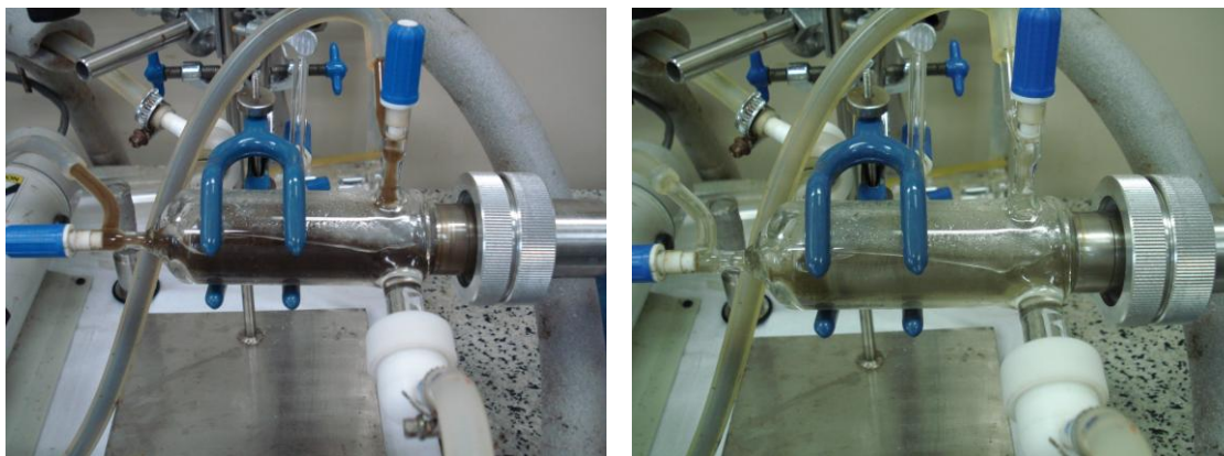
Figura 12 - Sequência da circulação de água após circulação da solução extratora. À esquerda a primeira etapa e à direita a segunda etapa.
