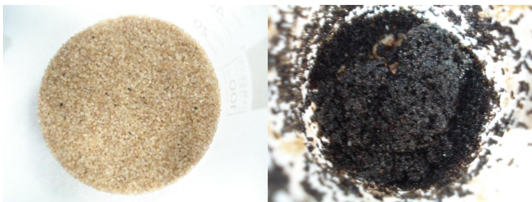
Figura 6 - À esquerda a areia de fraturamento 20/40 sem estar contaminada com o óleo. E à direita a areia já contaminada com óleo P-20 MRL 187
