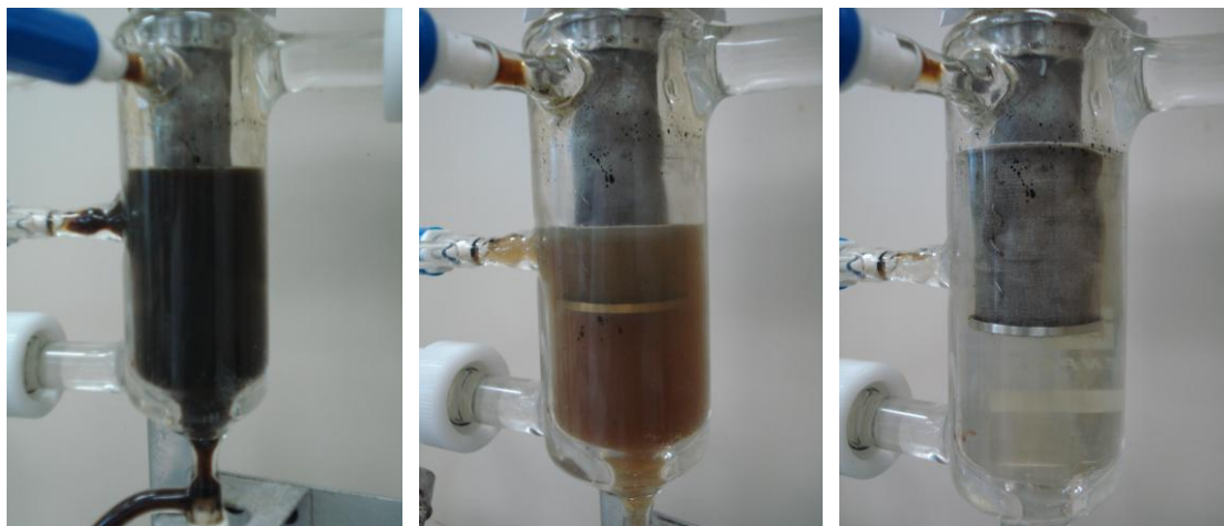
Figura 7 - Sequência da limpeza da areia. A primeira figura, da esquerda para a direita, mostra a circulação da Solução Extratora S. A segunda a circulação da primeira etapa da água e a terceira da segunda etapa da água
