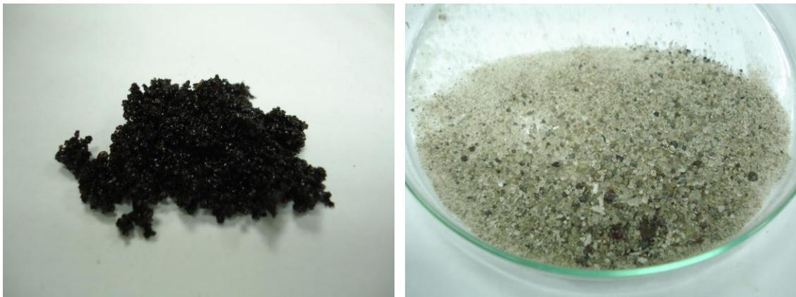
Figura 15 - Comparação da areia de produção antes do processo de limpeza, à esquerda, e após o processo com uso da Solução Extratora BN
