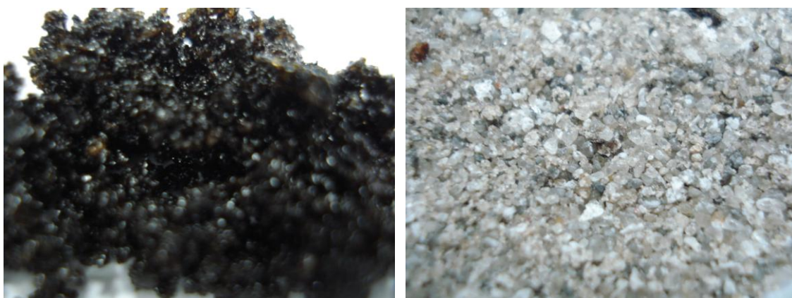
Figura 16 - Imagem aproximada dos grãos de areia de produção ainda contaminada com óleo, à esquerda, e após o processo de limpeza, à direita
