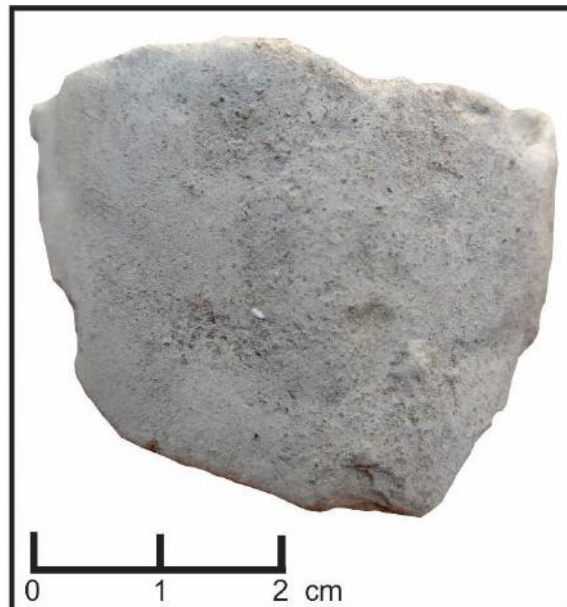
Figura 34 – Lamito levemente arenoso, com argilosidade de 88%, de coloração acinzentada e apresentando bioclastos fragmentados. Características observadas em 17,00 metros.
