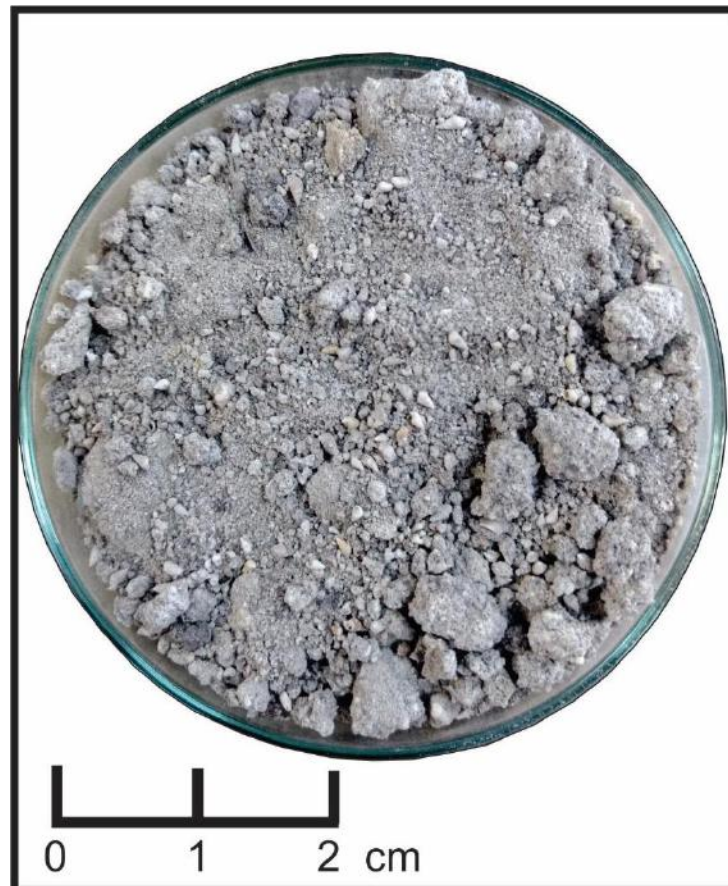
Figura 32 – Fácies Hab. Areia híbrida, subangulosa, essencialmente quartzosa, apresentando grânulos de quartzo, coloração acinzentada e argilidade de cerca de 2%. Os gastrópodes inteiros típicos dessa fácies ocorrem em proporções diversas (15 a 20%). Características observadas em 1,45 m.
