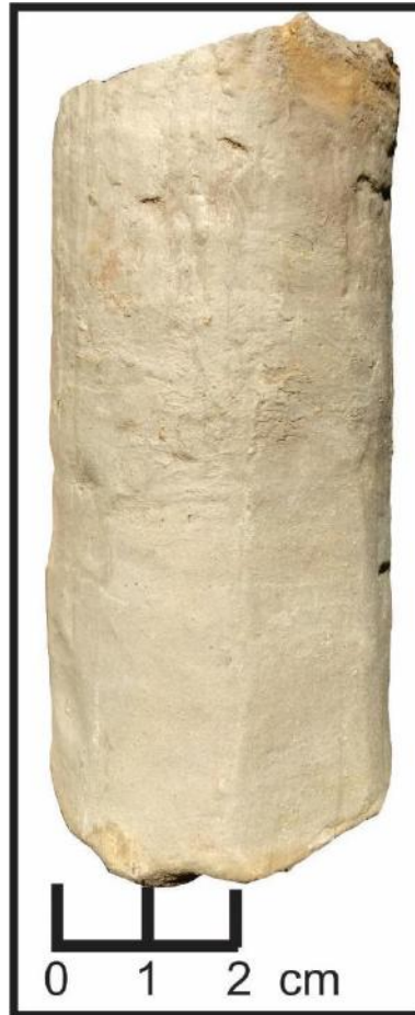
Figura 35 – Fácies La. Argilito arenoso com argilosidade de cerca de 90% apresentando manchas de oxidação. Características observadas em torno de 25,60 m.
