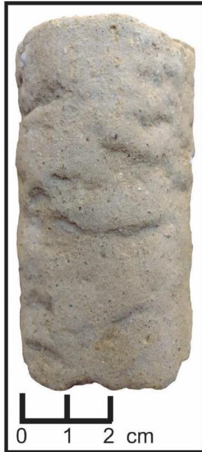
Figura 31 – Fácies Aa. Arenito fino inferior, composto por quartzo, feldspato, muscovita e biotita, apresentando grânulos de quartzo, com grãos subangulosos, mal selecionados e manchas de oxidação. Características observadas em 22,50 metros.
