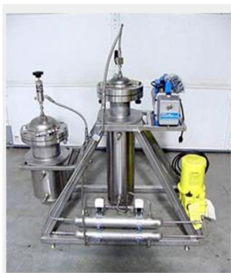
Figura 8: Sistema de extração por gás carbônico supercrítico
