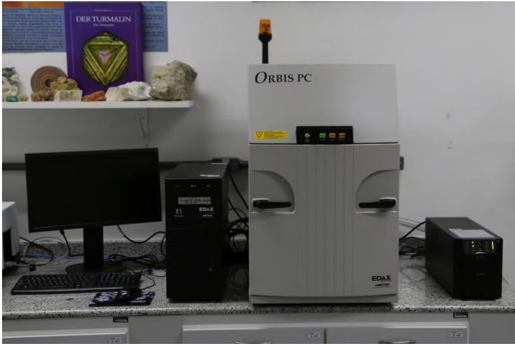
**Figura 15** Microfluorescência de raios-X utilizada para realizar as análises
