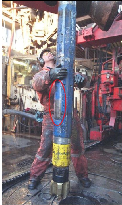
Figura 2.29: Push-the-bit . Detalhe para uma das ribs , responsáveis por “empurrar” a ferramenta contra a formação (Fonte: Baker Hughes)
