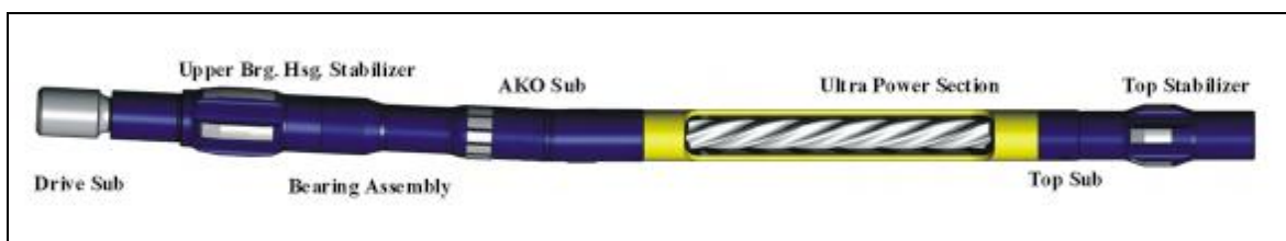
Figura 2.25: Motor Série Ultra da Baker Hughes Inc. O AKO sub representa o bent housing. (Fonte: Baker Hughes)
