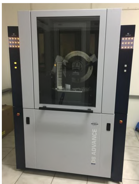
Figura 16. Equipamento Bruker-AXS D8 Advance Eco. Todas as análises feitas por difratometria de raios X (DRX) foram realizadas nele, com as condições padrão.
