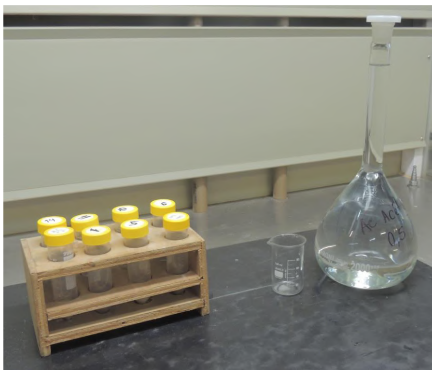
Figura 13. Capela onde foi realizado o procedimento para a dissolução de carbonatos com ácido acético 0,5 mol/L. As amostras encontram-se em tubos de ensaio apropriados para a subsequente centrifugação.
