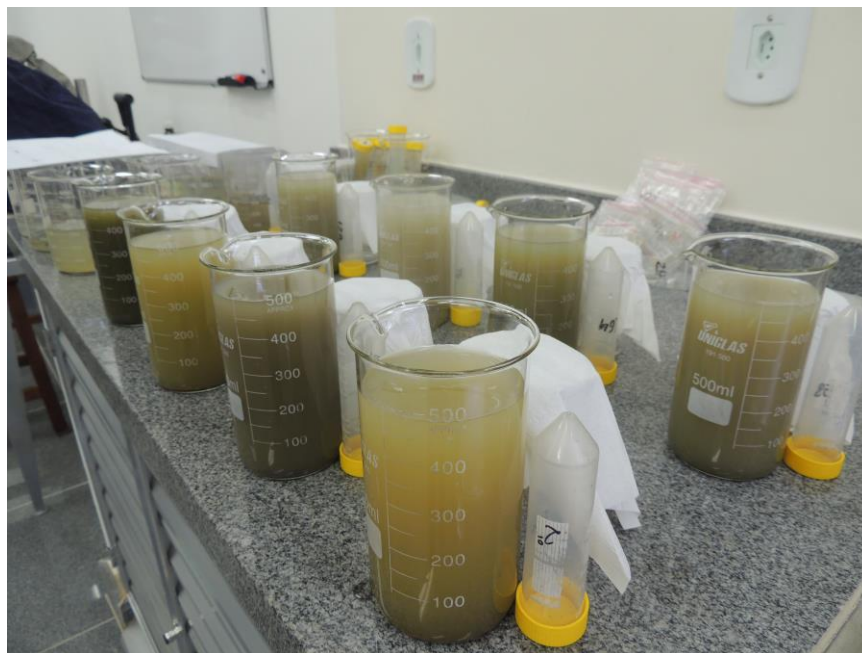
Figura 15. Processo de decantação das amostras em água deionizada em béqueres de 500 mL. Após 4 horas do início do processo, as partículas de tamanho argila ( <2 \mu\text{m} ) encontram-se em suspensão e serão retirados 5 cm (50 mL) para análises posteriores.
