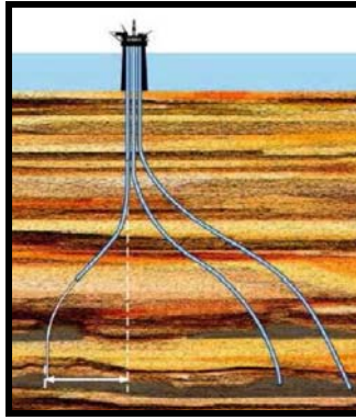
Figura 2.3: Perfuração de vários poços a partir de uma mesma sonda
