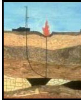
Figura 2.6: Poço de alívio
