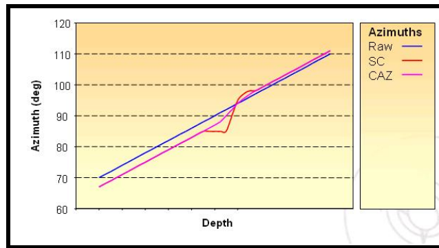
Figura 4.13: Correção simples no azimute através do Cazandra
