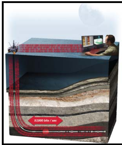
Figura 3.11: Telemetria por cabo
