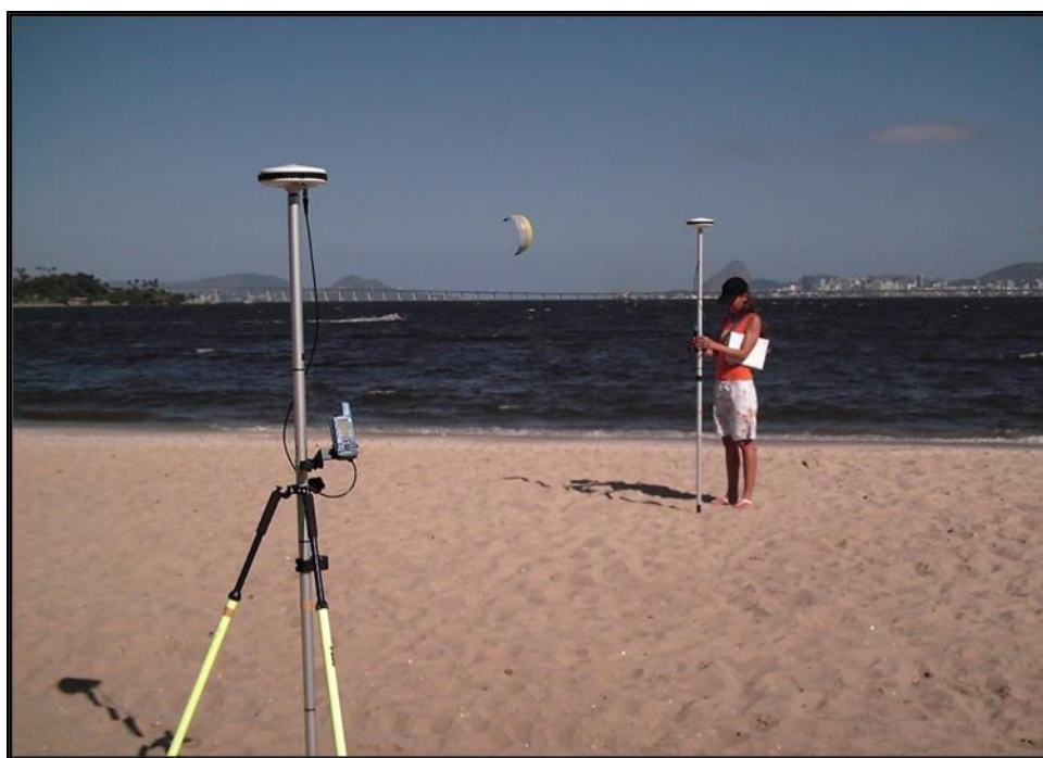
Figura 8: Rastreador DGPS Ashtech Promark 2. A antena fixa está com o tripé e a antena móvel aparece ao fundo.
