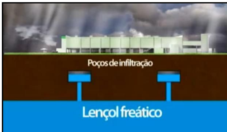
Figura 45 – Poços de infiltração - Fonte: Leroy Merlin, 2009
