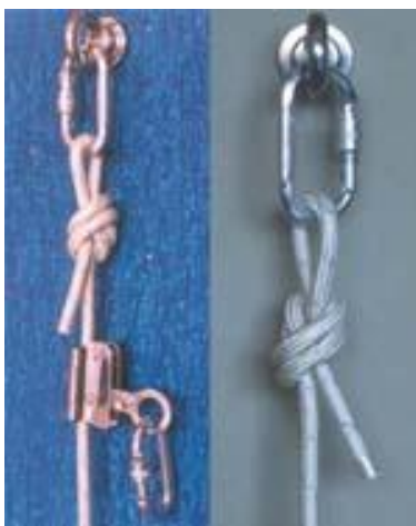
Figura 11 – Sistema de ancoragem para cabo guia de segurança Fonte: Manual de Segurança em Manutenção de Fachadas, 2003
